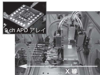
図3 9ch APD アレイを用いた高速応答型 X 線検出器
