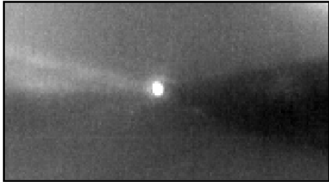
図 3 : STM 探針からのレーザー散乱光。左側の針状像が探針、右はその試料基板による鏡像。
