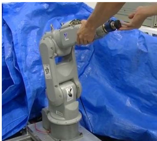
図2: トルク飽和時にも安全に動作する新しい力制御則。力センサへの接触力と、力センサ外への接触力の両方に安全に応答する。
