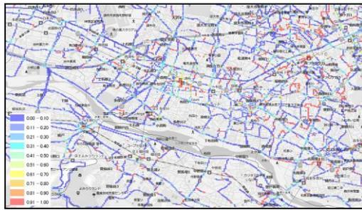
図 2 カープローブデータに適用した路面性状判定結果（東京都調布市，2015 年 3 月）
