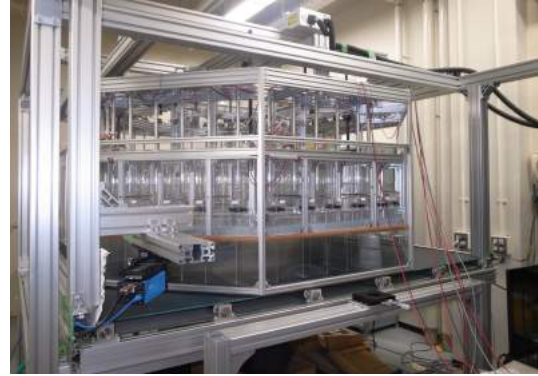
図6 開発された移動床付マルチファン・マルチベーン式竜巻シミュレータ
