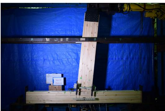
(a) 実大部分架構試験体(ト形)
