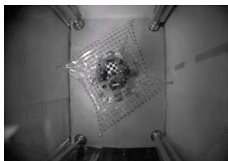
図 4 真空・微小重力下での展開実験
