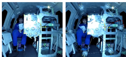
図12 自己展開トラスの微小重力下での展開
