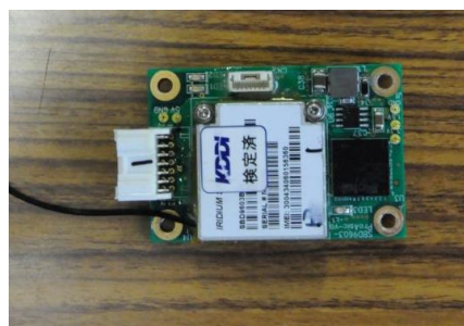
図 7：超小型衛星 EGG に搭載したイリジウム SBD サービスを利用した通信モジュール
