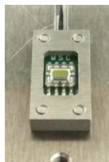
図 3：超小型衛星 EGG 用に開発した受動型光センサの外観
