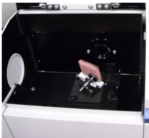
図3 蛍光強度測定部に設置した試料
