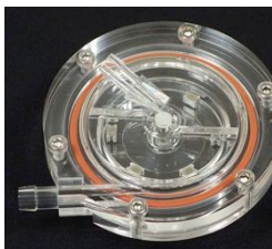
図5 血液浄化用小型遠心ポンプ3号
