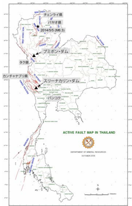
図 1 タイの活断層分布と 2014 年 5 月 5 日の地震の震源（DMR の活断層図に追記）
