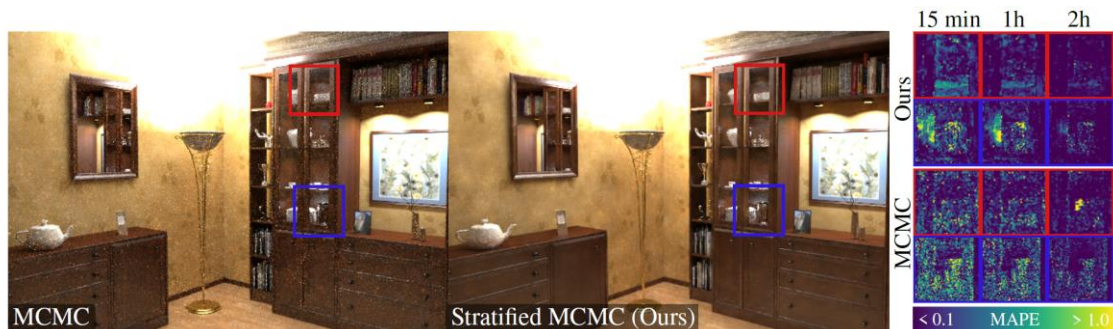
図5 : 同計算時間での層化サンプリングがない従来の MCMC と、我々の手法 (Ours) の比較
