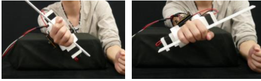
図3 円盤の回転方向制御により、手首の旋回方向を制御
