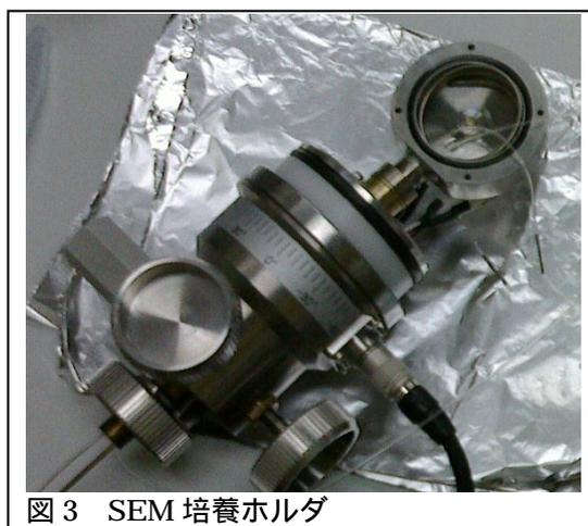
これらの開発した技術を統合して、液中の現象を動的に電子顕微鏡で観察することに成功した。具体的には、気泡や液滴、シアノバクテリアの動態観察を行った。電子線の加速電圧は 17 kV、走査速度は 0.2-30 fps で行った。
