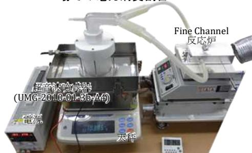
図2 高知工科大学にあるミストCVDシステム。簡便な装置にもかかわらず、大気下で高均一・高品質な機能薄膜作製が可能。
