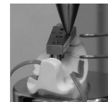
図4. 被圧変位量の測定
