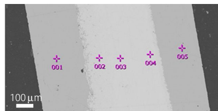
図 2. FeSe 丸線材(800°C, 10 時間の熱処理)の断面 SEM 像。
