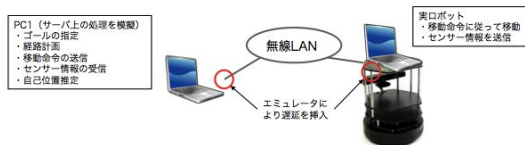
図6：遠隔ナビゲーションシステムの構成
