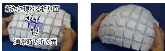
(b) 新たな折り面への情報表示 (b) 曲げによる形状変化 図1 折り紙テッセレーションの外観 (Water Bomb)
