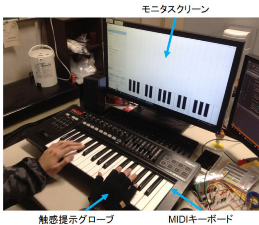
図9. 触感提示型ピアノ教示システムの外観 バイブレータ
