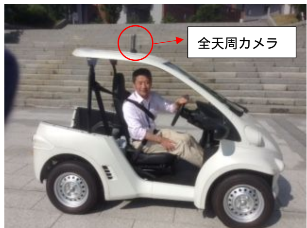
図3 小型電気自動車の屋根に取り付けられた全天周カメラ
