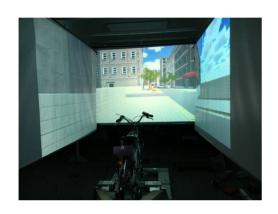
(2) 自転車シミュレータについては,人間が乗って,仮想空間の街中を自由に走行できるフェーズ1のシミュレータを開発できた.上図は,仮想空間を投影している状態を示すただし,現状では,体を左右に傾けて体重移動させた際の,自転車走行へのフィードバックができていない.このため,走行に不自然さが残る.今後は,体の傾きを用いた走行実験を通じて,ハザード検出手法の研究,おいい,特に高齢者や神経疾患者の運転能力の評価の可能性を追究したい.
