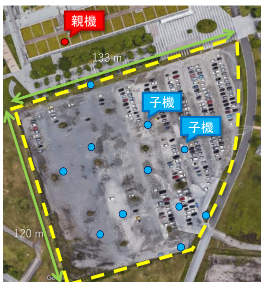
図1 PAN と GPS を使った位置推定
