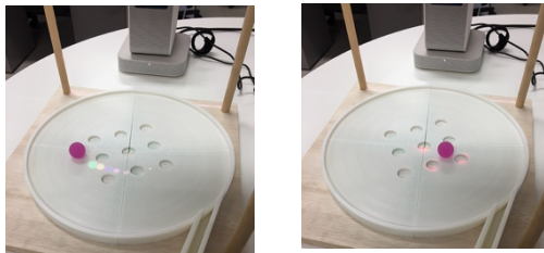
図 4. ボールの位置に応じた演出. 左: ボールの軌跡表示. 右: 落ちそうな穴の強調表示.
