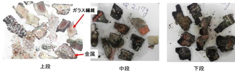
図2 超臨界水で処理した廃電子基板の状態
