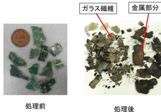
図1 超臨界水処理前後の廃電子基板の変化
