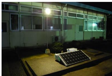
図 1 木綿を材料にした蓄電器を利用した夜間照明 (2013.12 申請者らが作製) (LED : 10W, EDLC : 100Wh, 6V)
