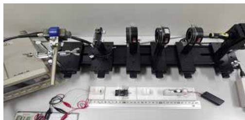
図2 市販の実験系(奥)とブロック状光素子素子を用いた実験系(手前)
