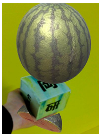
図3 立体マーカ―を用いた AR (上下2面に対応した表示)
