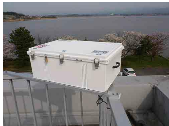
図2 柴山瀉から見える白山の雪形を1時間毎に撮影している。画像データは無線LANを介して回収する。
