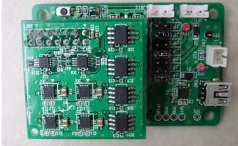
(d)加速度センサとして組み上げた状態
