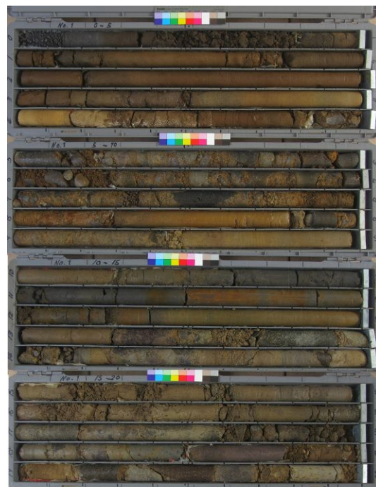
図3 ボーリングコア写真
