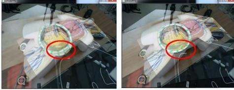
図5 TPS 導入前後の合成処理(左)導入前, 赤枠内にズレがある(右)導入後, 赤枠内のズレが軽減されている
