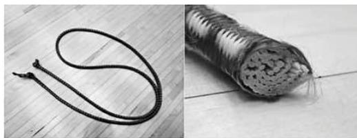
図 1 伸縮ロープとその断面
