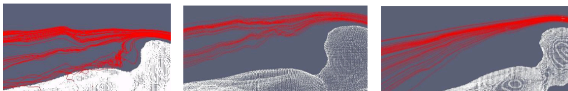
図 6 頭頂部付近の流線の比較. 計算開始時から 0.16s 時点での気流状態を示す.
