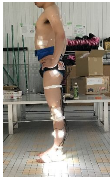
図 2 高輝度 LED による自発光マーカーを装着した泳者
