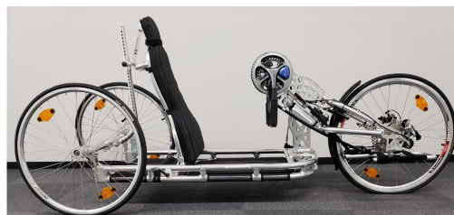
図2 製作したリカンベント型ハンドバイク ただし、計測用にチェーンを取りはずしている。また、パワーメータを取り付けるためにクランクとペダルを変更しているが、初期状態のペダルはブレーキおよび変速ケーブルに接続されて格納されている
