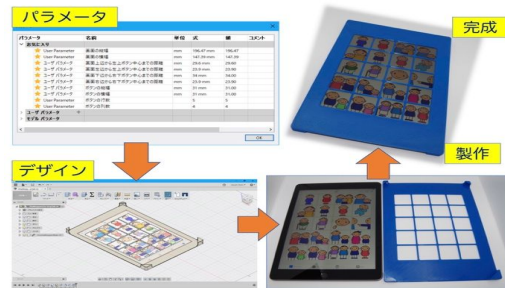
図3 タブレット・スマホ用キーガード設計例
