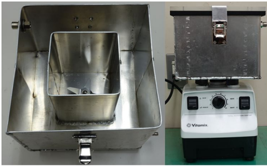
図2 ナノフィブリル化を狙ったミキサー容器
