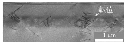
図 8 Si 堆積速度= 2 \text{ \AA/s} で成長した試料の TEM 像
