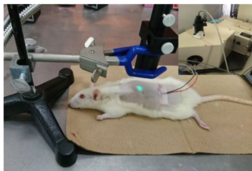
図 4: ラットへの埋め込み後の光入射に伴う発電特性の測定。
