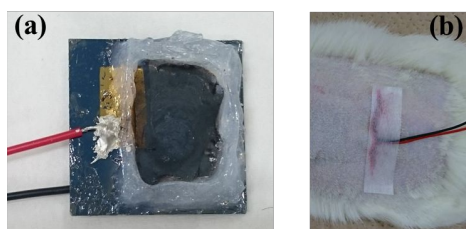
図 3: ラットへの埋め込み用発電デバイスの作製(a)と埋め込みプロセス(b)。
