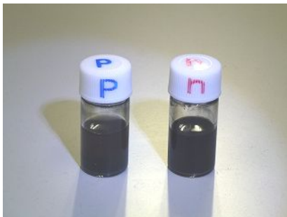
図1 Bi-Te 熱電インク
