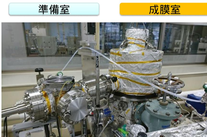
図 2 ローディングチャンバー (準備室) を備えた、新規な低ダメージ高周波重畳マグネトロンスパッタ装置
