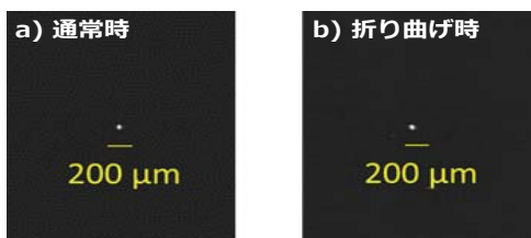
図 9. PDMS フレキシブル光導波路の折曲時と通常時の NFP 観察例。極めて小さな曲率半径においても通常時と同等の光導波を確認。
