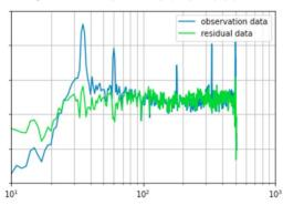
左図: ARMA による検出器雑音の低減の結果。横軸は周波数(Hz単位)で、縦軸は検出器感度(任意単位)。 青線が元々のデータで、緑線が ARMA による雑音除去後のデータ。検出器雑音のうち、線状の雑音が削除されていることがわかる。
