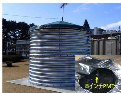
図 5.  $\phi 3 \text{ m}$  水槽と入口 ( $\phi 0.8 \text{ m}$ )
