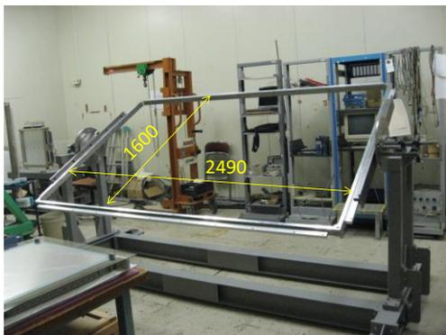
図 8. 回転機能付き大型チェンバー組立装置とテストチェンバー(1600mm×2490mm)
