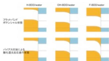
図2：ボロンドープダイヤモンド電極の終端の違いによるバンドアラインメントの差異。
