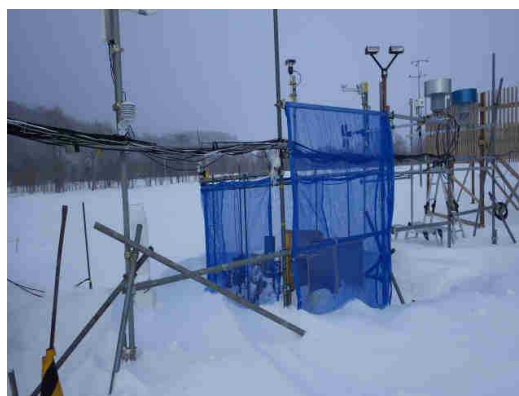
図 3. 観測風景。高さ 2m の位置に光学式雨量計、地上の防風ネットの内側には、天秤式降水量計や降水粒子自動観測装置を設置した。
