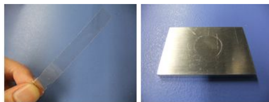
図4 左:3官能アントラセンの光硬化物からなる薄膜(膜厚0.1mm)、右:アルミ板状に形成した塗膜
