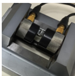
図 1 立方体試験片（音響プローブに挟んで設置）を用いた異方性ガラスの共振法弾性率測定。
